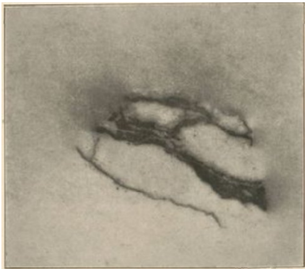
Tavola I: Prova ottenuta con una lastra di minerale (pechblenda di Cornouailles)
